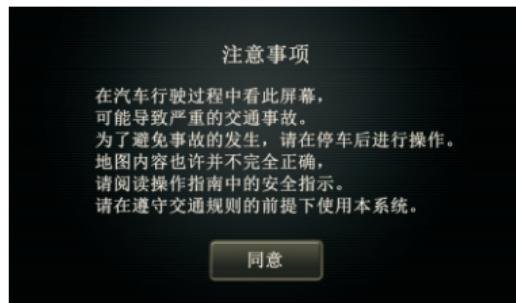
按下(同意)按钮,进入上次关机时的界面。将ACC调至OFF (关闭引擎),则电源关闭,本机自动保存当前的页面,下次开机时将进入该页面。
