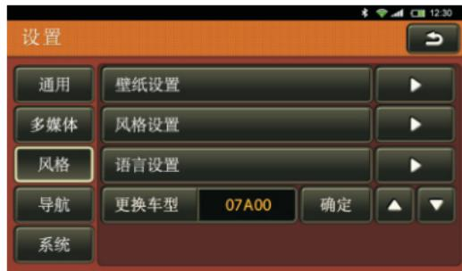
(壁纸设置)：点击(▶)按钮进入(壁纸设置)界面，可根据个人爱好去选择不同风格的墙纸。
