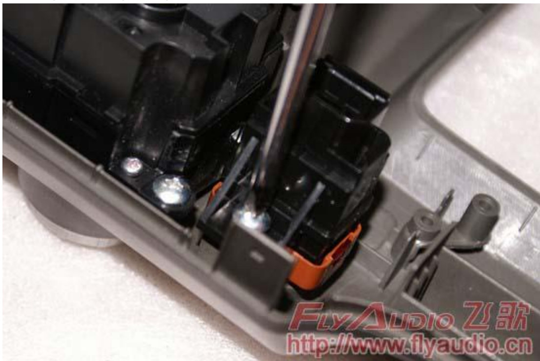
24. Fixing hazard light plug.
